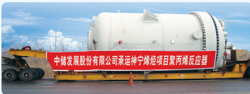
» 中储股份为神宁烯烃项目配送聚丙烯反应器
